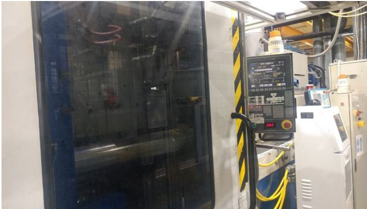
Inyectora serie Meteor 650 con Servosistema "De doble Rodillera"
